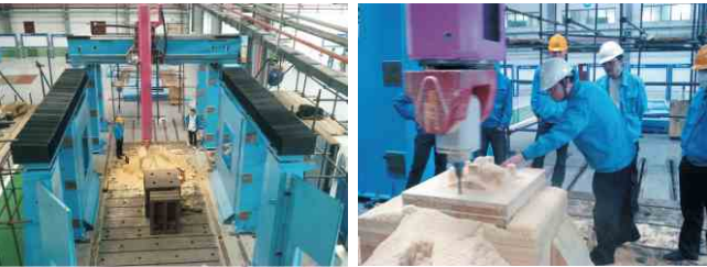
东汽集团五坐标联动龙门加工机床，在双电机同步驱动下，可达到最高移动速度80米/分
