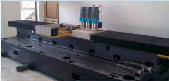
3进给轴同步消隙机械结构
