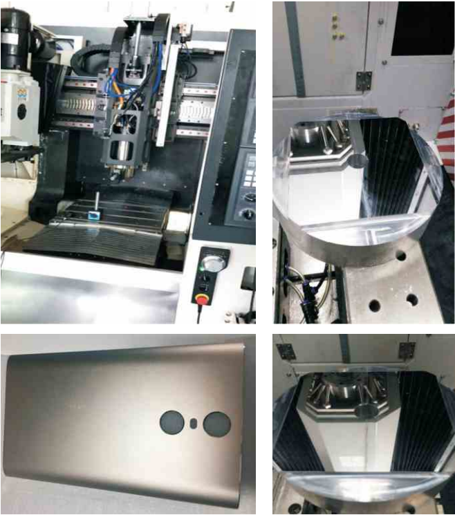
配置EatherCAT高速总线和直线电机的高光机和加工的零件
